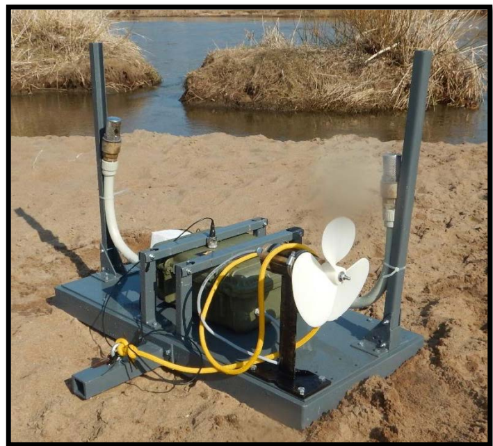
Rysunek 3 prototyp goldfish-light wyposażony w turbinę wodną do generowania energii
