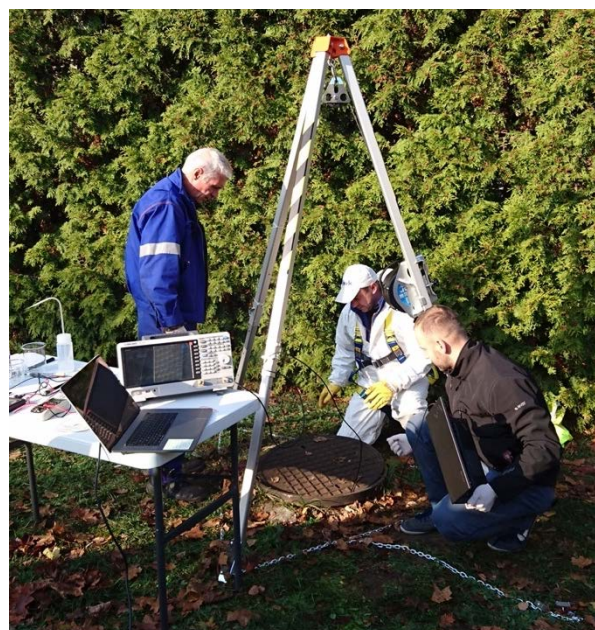
Rysunek 6 Testowanie zasięgu komunikacji systemu micromole'a w kanalizacji
