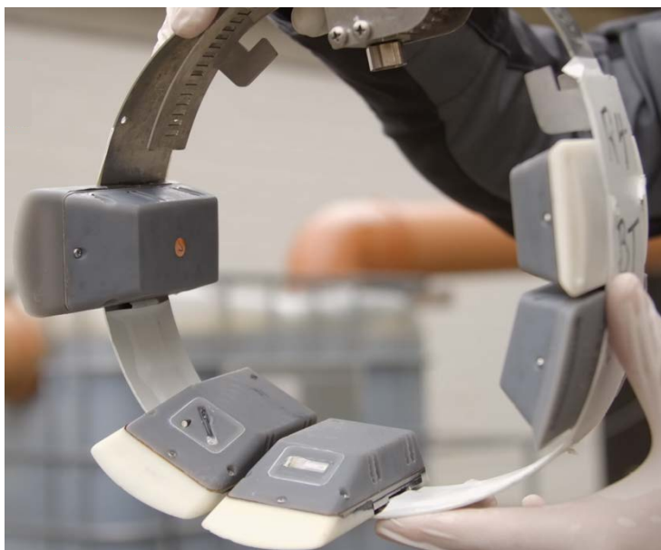
Rysunek 5 Pierścień micromole wyposażony w czujniki EC oraz pH
